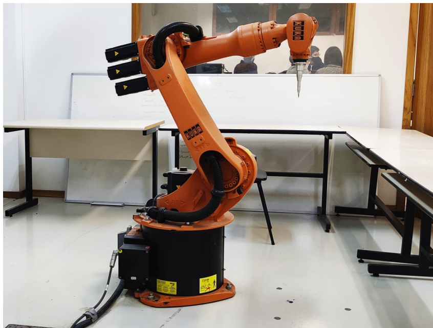
Figura 9: KUKA KR16-2 instalado na Escola Politécnica da USP (Fonte: Autores)
